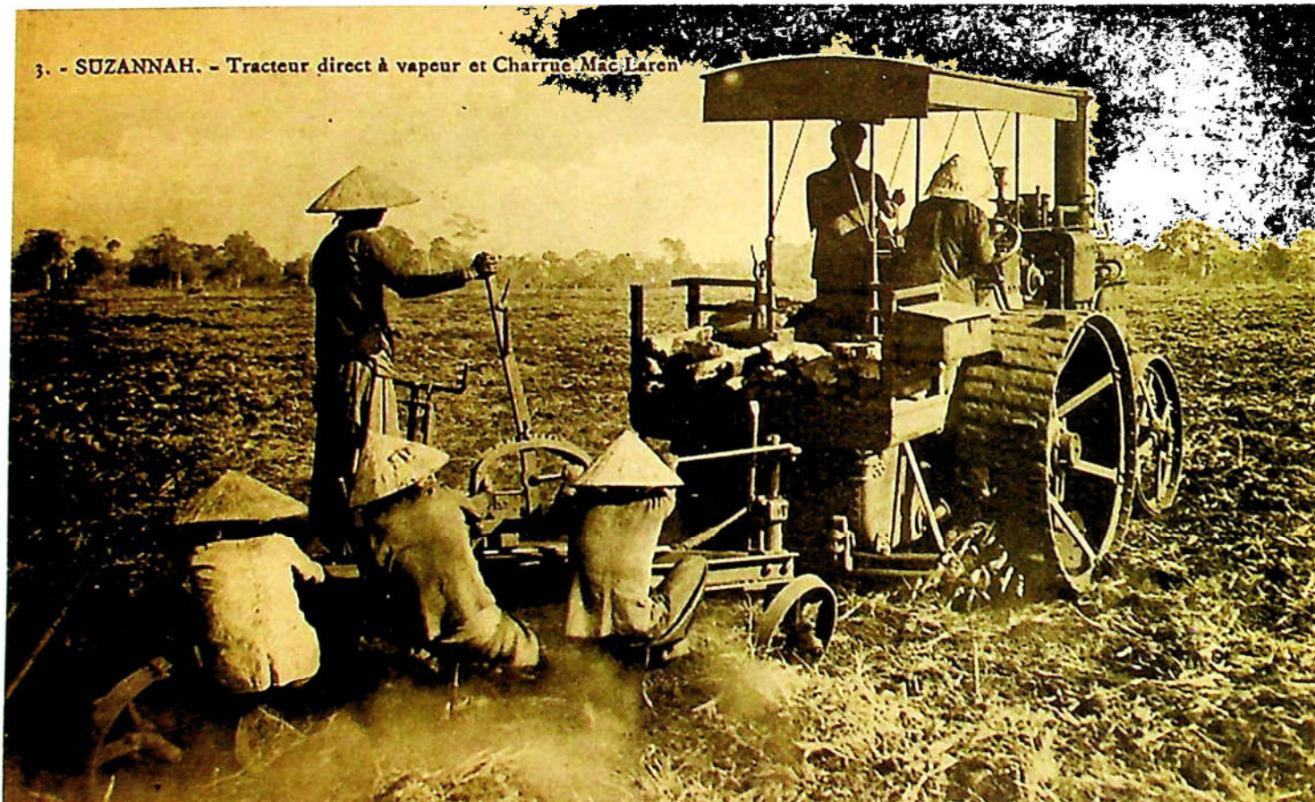
Hình 73. Đồn điền nông nghiệp Suzannah. Máy cày bằng động cơ hơi nước MAC LAREN. Nguồn: delcampe.net
